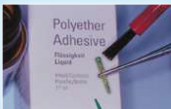
Mettre de l'adhésif sur les pivots.
