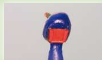
La modélisation terminée avec tige de fusion prête pour être fondue.
