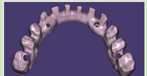
Structure modélisé au CAD, prête à être accomplie. Dans les trous seront scellés les piliers en titane Extragrade.
